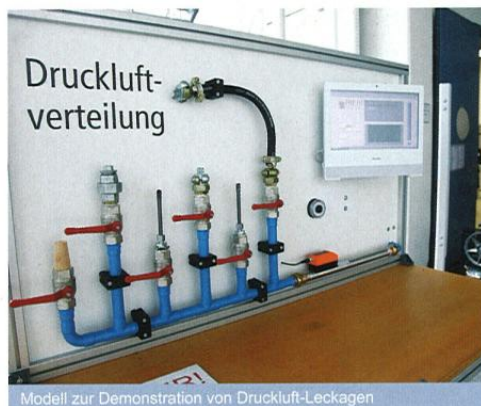
Modell zur Demonstration von Druckluft-Leckagen
