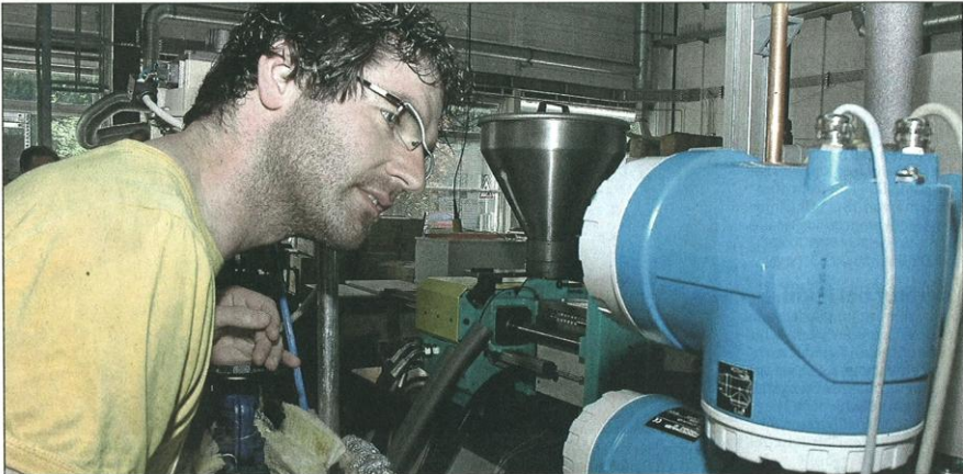
Sparexperimente im Labor: Diese Kunststoff-Spritzgussmaschine wird mit Gas statt mit Strom als Energiequelle aufgeheizt. Uni-Techniker Benjamin Rommel kontrolliert die Temperatur. Auch die Kühlung der Maschine soll effizienter werden. Fotos: Dilling
